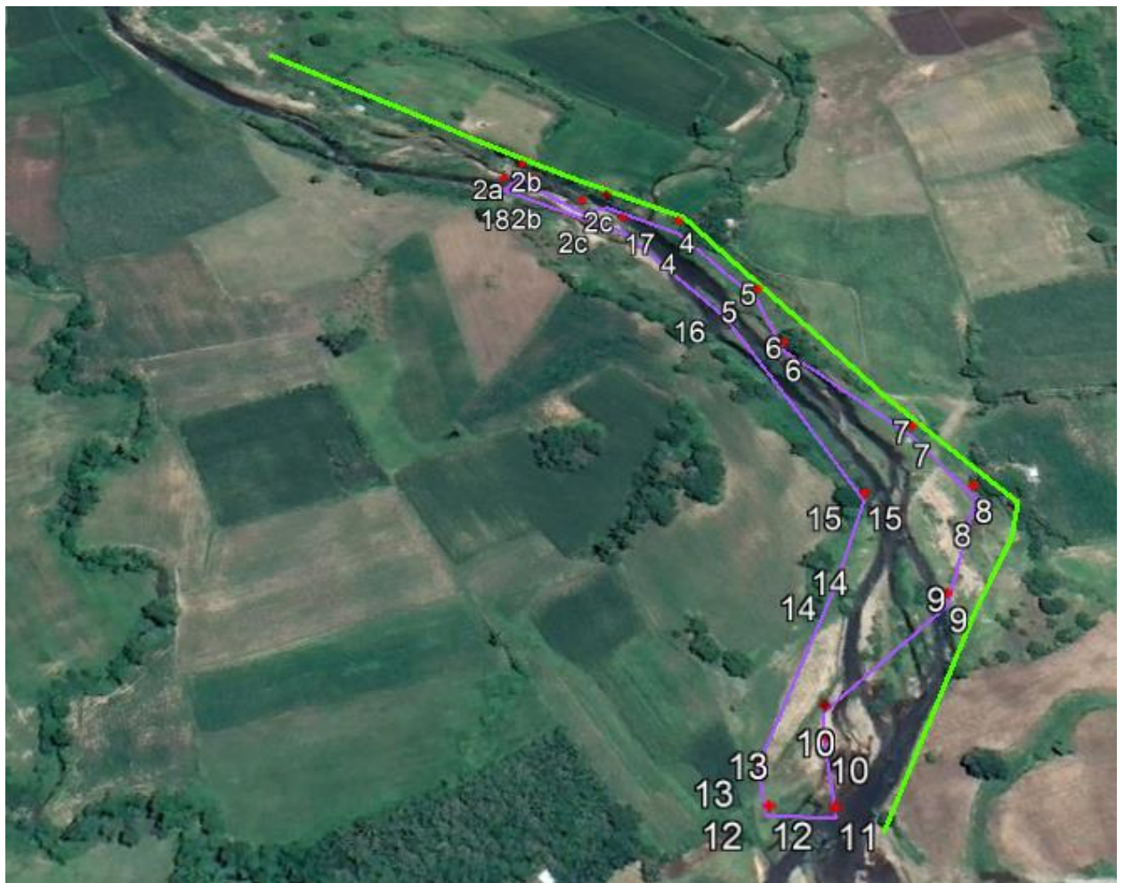
Hình 1.3. Các điểm bảo vệ và gia cố bờ sông
